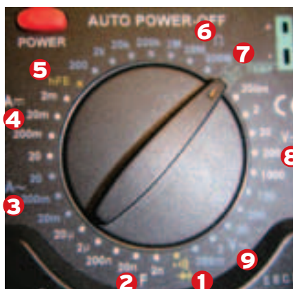
1. Режим прозвонки. 2. Режим измерения емкости (F). 3. Режим измерения переменного тока (~A). 4. Режим измерения постоянного тока (A). 5. Режим проверки коэффициента усиления транзисторов (hFE). 6. Режим измерения сопротивления. 7. Режим измерения температуры. 8. Режим измерения постоянного напряжения (V). 9. Режим измерения переменного напряжения (~V).
