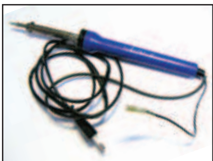
Обычный недорогой (около 200 р.) паяльник, имеет контакт для заземления и регулировку мощности и температуры с автоматической поддержкой установленных значений.
