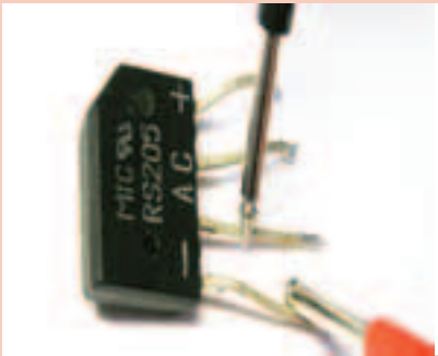
Рис. 2 Прозваниваем диодный мост. Какой щуп к какой ножке прикладываем - неважно, проверять надо в обе стороны. В одну сторону сопротивление должно быть порядка 500 Ом, в обратную - больше мегаома. Диод должен прозваниваться при подключении красного щупа к аноду, а черного к катоду. Соответственно, ориентируясь по схеме выпрямителя на принципиальной схеме, прозванивать надо ножки: 1-2, 1-3, 2-4, 3-4.
