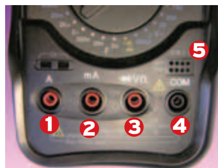
В зависимости от того, куда подключены щупы, будут производиться разные измерения. Черный щуп вставляется в 4 гнездо, как ты видишь, на фотографии оно тоже черное. Щупы можно вставить и наоборот - от этого ничего не изменится, различие по цветам сделано для удобства.
