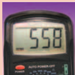
Вот что показывает прибор, значит транзистор не замкнул накоротко. Прибор показывает сопротивление транзисторного перехода в Ом-ах.
