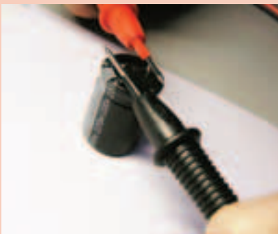
Рис. 4 Прозваниваем силовой конденсатор. Черный щуп (земля) прикладываем к ножке, помеченной «-», красный - к ножке «+».
