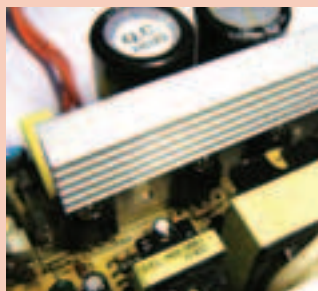
Рис. 5 Силовые транзисторы придется снять вместе с радиатором, иначе их не проверить, а также не подлезть к другим элементам схемы.
